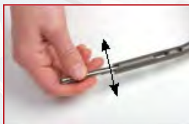
Einsatz zu klein. Er wackelt. Insert too small. It wobbles.
